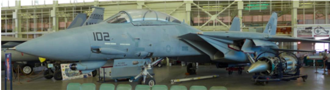
これは、グラマンF-14トムキャットだそうです。この飛行機は、可変翼という主翼が、飛行速度に応じて、最適な幅に調整できるということだそうです。
